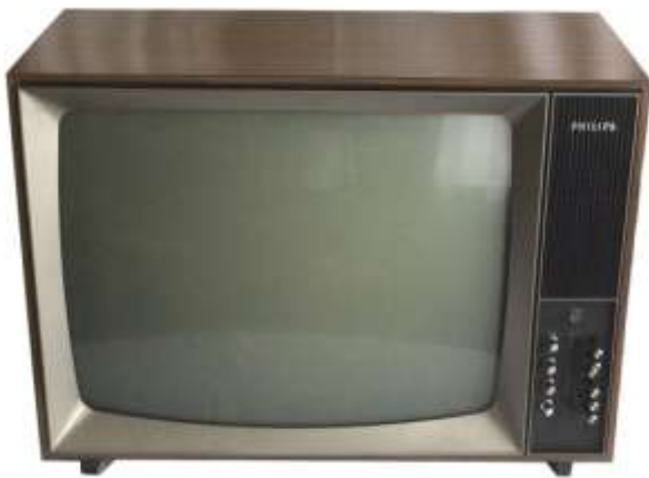
PHILIPS Regent 24 Automatic A24T680 , Schlicht und schön, ein echter Hybrid – mit 7 Röhren, 16 Transistoren und einem integrierten Schaltkreis (Sammlung B. Schleser)
