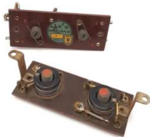
"Vorgefiltert" RKF/Stuzzi Fertigspulensätze bzw. Filter für den Radioselbstbau um 1948 (Sammlung W. Scheida)
