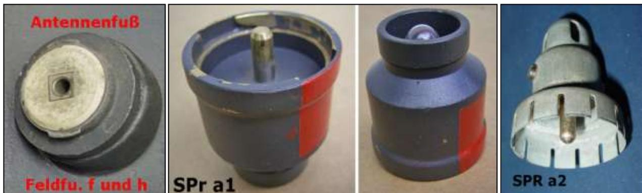
der **Senderprüfer a2** eingeführt worden, der sowohl für die Feldfunksprecher f und h als auch für die Kleinfunksprecher d und K geeignet war (rechts im Bild).
