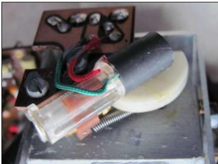
Ausschlaggebend dürften die Platzverhältnisse und das Gewicht gewesen sein. Vielleicht war auch ein Zweifachdrehko leichter zu beschaffen als ein Dreifachdrehkondensator. Bei Verwendung eines Dreifachdrehkondensators muss neben diesem auch eine justierbare Induktivität Platz finden.
