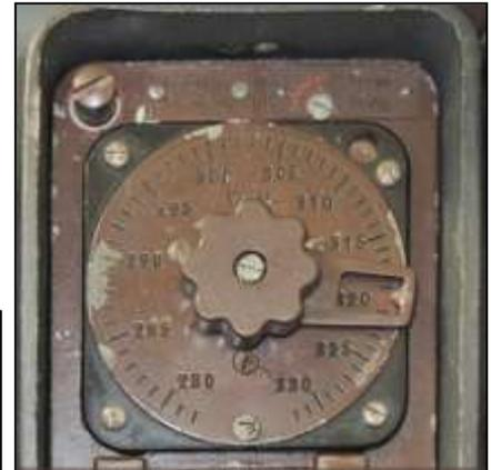
3. Abgleichschraube am Feldfunksprecher mit Schraubenzieher (isolierte Seite) langsam nach rechts oder links drehen, bis Überlagerungston im Fernhörer des Frequenzprüfers zu hören ist. Überlagerungston nicht auf Schwebungslücke abstimmen.
