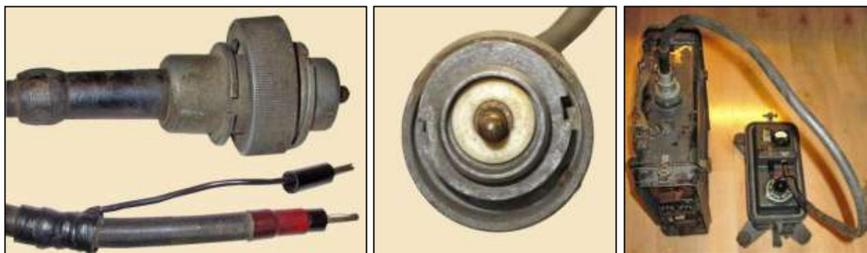
oder ein ähnlicher Steckverbinder auch für Prüf- und Messzwecke in den Herstellerwerken und Armeenachrichtenwerkstätten verwendet worden.
