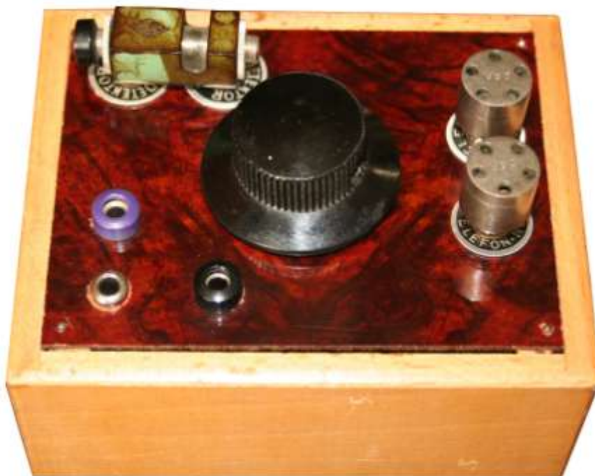
Apparat mit eingesetztem Detektor und Telefonverteiler-Stecker
