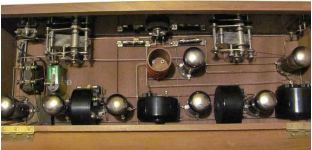
Blick auf das Innenleben, in der Mitte ist die beschriebene Spule von oben zu sehen
