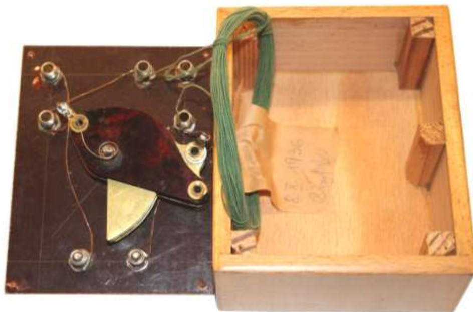
Innenansicht des Detektorapparates
