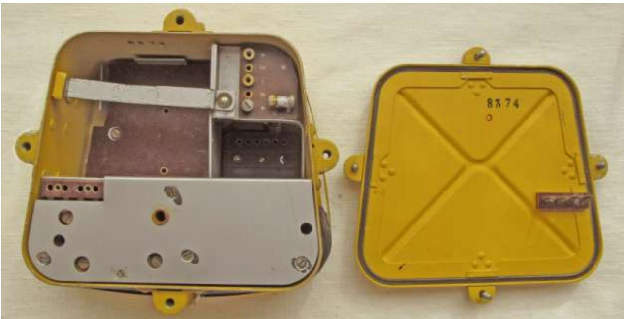
Der Raum für die Batterie ist leer. Mir ist keine original erhaltene RS 28 bekannt. Rechts im Anschlussfeld für die Batterie ist der Sikatrop-Kondensator C17 zu sehen, alle späteren NS4 haben nur noch die Löcher in der Pertinaxplatte. Den Raum für die Tastuhr schließt nach unten die Kontaktplatte für sechs Stiftkontakte ab. Gerät und Deckel werden mit vier Kontaktstiften verbunden. Der **Prüfdeckel PDNS4** mit Instrument greift auf diese Kontakte zu, um Anodenstrom und Antennenstrom zu messen.
