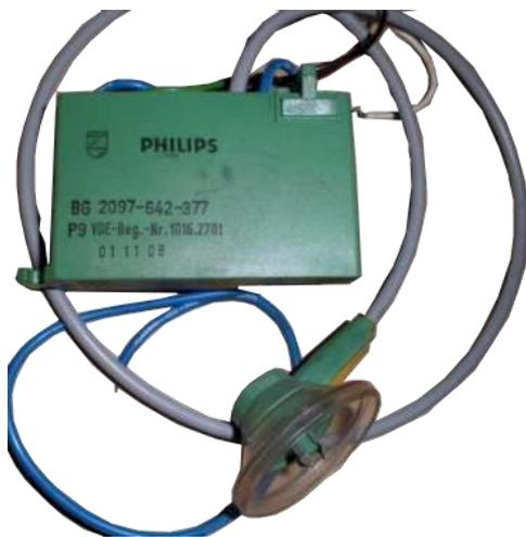
**Symbolbild für die obligatorische Hochspannungskaskade für das viel verbreitete Volltransistor PHILIPS K9 Chassis der 1970er Jahre**
