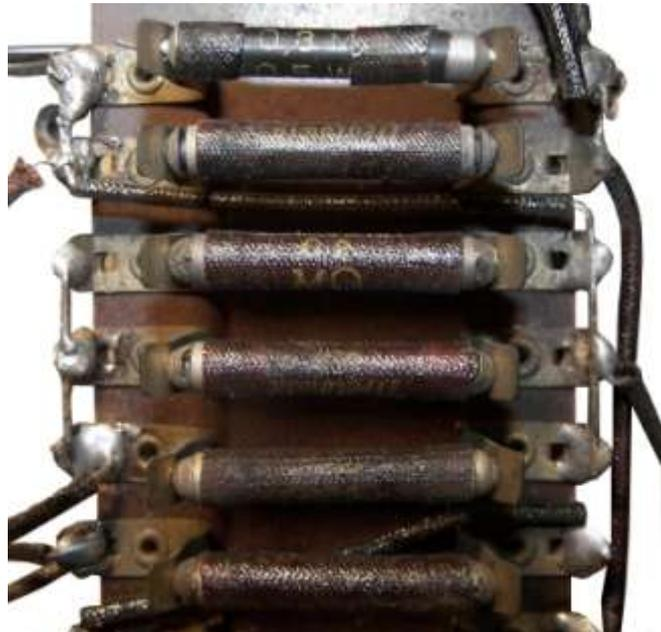
**Typischer Schaltungsaufbau in Klemmtechnik (ca. 1933)**
