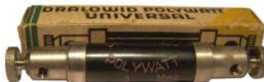
**Rechtes Bild: Ein Widerstand in gleicher Bauform, mit Schachtel**
