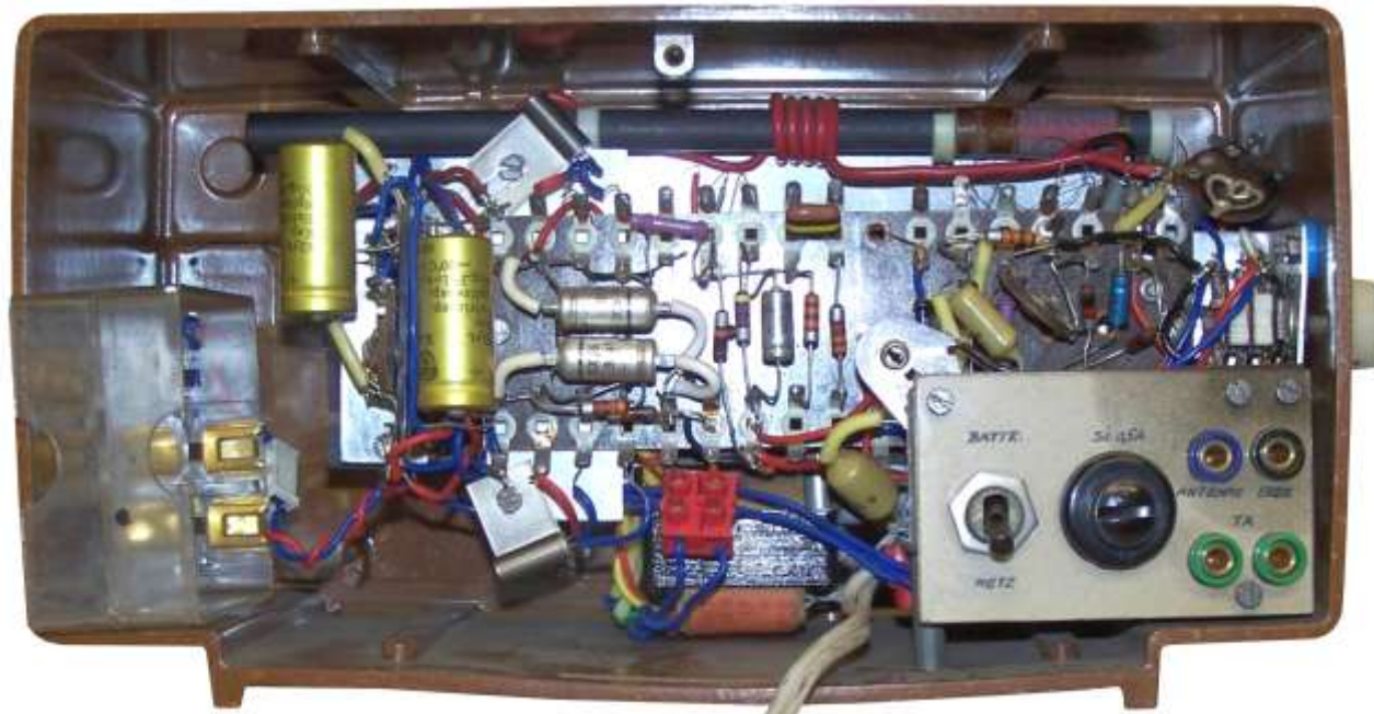
Innenansicht des Eigenbaugerätes im Gehäuse eines HORNY "Page" für Netz- und Batteriebetrieb, zusätzlich ist ein Anschluss für einen Plattenspieler (grüne Buchsen) eingebaut worden.
