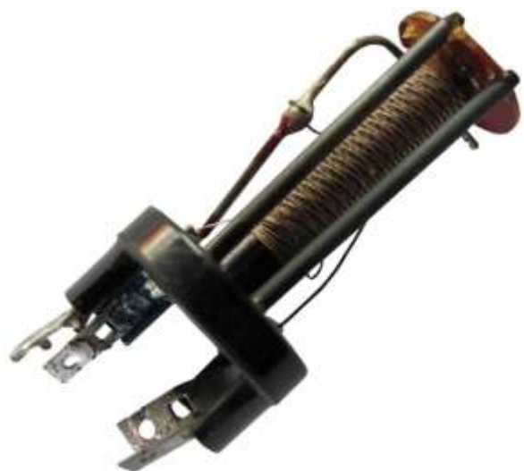
Rechtes Bild: Die Abstimmungsspule bei abgenommener Haube
