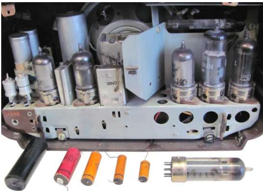
Ansicht von hinten mitsamt der getauschten Teile
