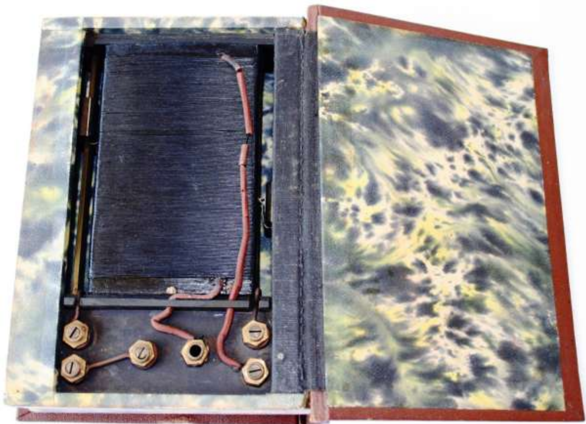
Detektorapparat in Buchform: Offene Rückseite
