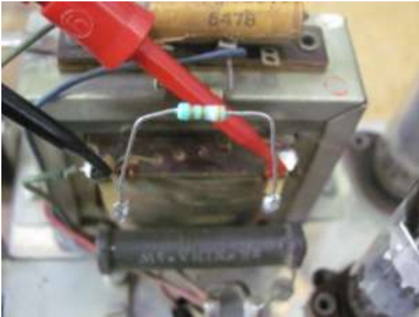
Ausgangstransformator mit Lastwiderstand
