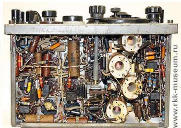
Die HF-Spulen sind auf Keramikspulenkörpern aufgebaut und abgeschirmt, der Vierfach-Drehkondensator hat ein verlötetes Gehäuse aus Messingblech.
