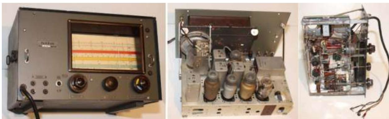
Es folgten Entwicklungsaufträge über je zwei leistungsfähige **Funkhorchempfänger y** (Kurzwellen) **und z** (Längstwellen). Beide waren bei Kriegsende auch bei Lorenz noch nicht über das Entwicklungsstadium hinaus gekommen. Es hat vermutlich nur eine Musterfertigung des Fu.H.E.z gegeben.
