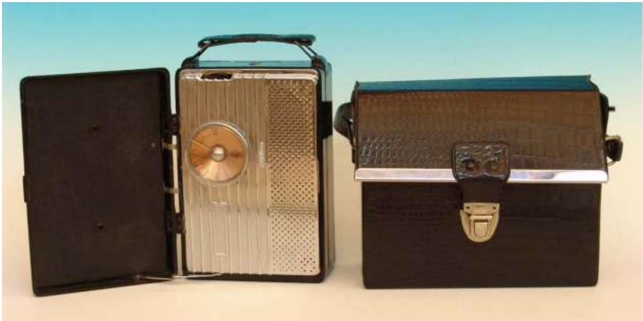
Volumsmäßig das kleinste und auch leichteste Gerät typisch amerikanischer Bauart. Mit originaler Tragetasche als Umhängeradio zu verwenden. Zum Betrieb muß jedoch der Deckel des Gerätes geöffnet werden. Dabei wird das Gerät automatisch eingeschaltet. Im Deckel ist eine Rahmenantenne integriert. D.h. die Tragetasche ist wirklich nur zum Tragen, für den Betrieb muß es herausgenommen werden. Technisch ein 4-Röhren-Batteriesuper mit 6 abgestimmten Kreisen, geeignet für Mittelwellenempfang.
