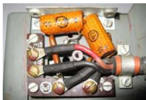
entstört. Die über den Wechselrichter geführte Heizspannung für den Empfänger wird ab den Sammlerklemmen **vierdrähtig** geführt und über ein sehr niederohmiges NF-Filter zusätzlich vom Zerhacker entkoppelt. Der Schalter darf nur  $0,015 \Omega$  Übergangswiderstand haben. Elektrolytkondensatoren  $700 \mu\text{F}$   $6/8 \text{ V}$  und  $16 \mu\text{F}$   $220/250 \text{ V}$  sowie Sikatropekapazitatoren zur Funkenlöschung tragen zur Siebung bei.
