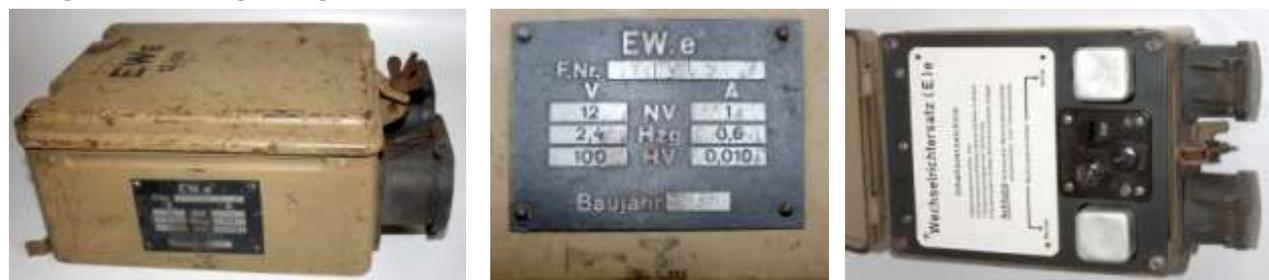
Widerstand 4-12 V/0,6 A ohne Vorwiderstand zur Stabilisierung der Heizspannung aus. Die letzten der etwa 9000 EW.e hatten ab Mitte 1944 ein erdgelbes Stahlblech-Gehäuse und das Fertigungskennzeichen ryl ohne Geräteummer (Bild oben).
