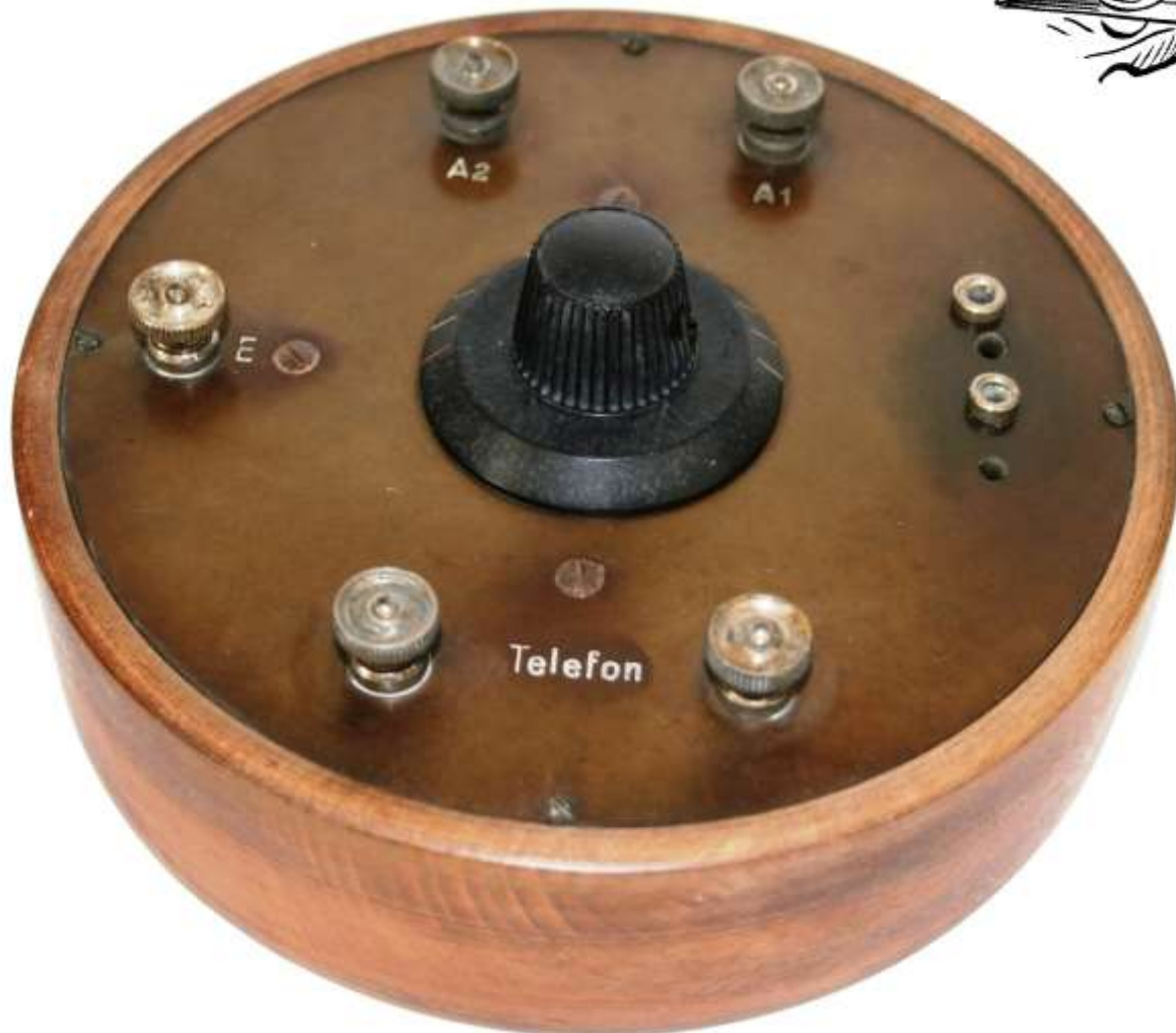
ERICSSON LA 20w in Nussausführung mit umgebauten Detektorbuchsen
