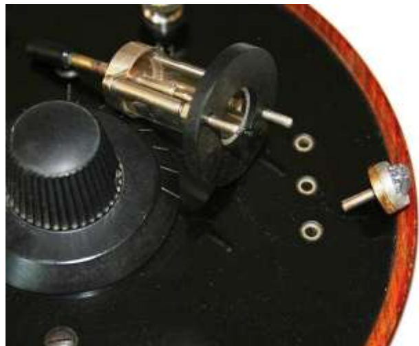
Originaler Aufsteckdetektor des LA 20w
