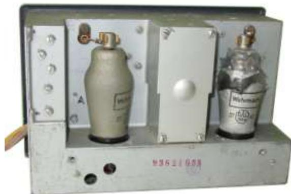
Die Empfänger EBl1 sind 1940 teilweise durch die gleich großen, wesentlich leistungsfähigeren Überlagerungsempfänger EBl3F bzw. EBl3H ersetzt worden. Mit denen ist die Blindlandeanlage FuBl II zusätzlich noch zur Langstreckennavigation mit scharf gebündelten und schwenkbaren Leitstrahlen eingesetzt worden („Knickebein“).
