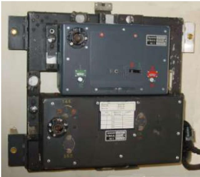
Für den Einbau der Empfänger in verschiedene Flugzeugtypen gab es mehrere Arten von federnd aufgehängten Aufhängerahmen. Hier ist der AR4 abgebildet. In jeweils drei arretierbaren Schlössern werden die Winkel am Gehäuse mit wenigen Handgriffen eingerastet. Ein bzw. zwei Kabelschwänze dienen zur lösbaren Verbindung mit der Bordverkabelung.
