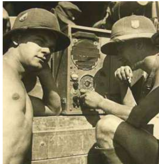
Ein WR 1/T m.Rü. in Afrika. Der Lautsprecher ist „sanddicht“ gemacht.. Das Gerät hat noch keine Buchse für den Kopfhörer!
