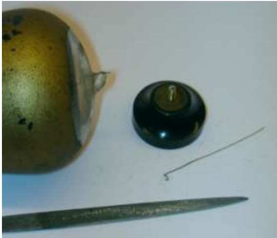
Bild 3: Verlängerungsdraht und Anodenkappe
