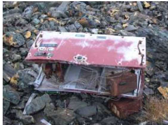
Reste eines Netzanschlußgeräts SGLE 0,2/2 der Station „Nußbaum“ nach über 60 Jahren auf Spitzbergen (August 2005) (Foto: Dege)
