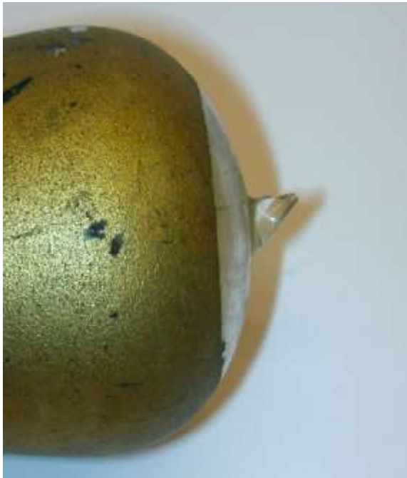
Bild 1: Röhre mit abgerissener Anodenzuleitung
