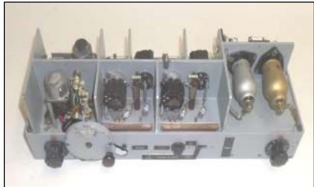
Ausgang für trägerfrequente Mehrkanalübertragung. Der ist erst nachträglich eingeführt worden und an der recht provisorisch nachgerüsteten RV12P2000 zwischen den beiden Röhren CBC 1 und CC 2 zu erkennen (siehe Bild unten).
