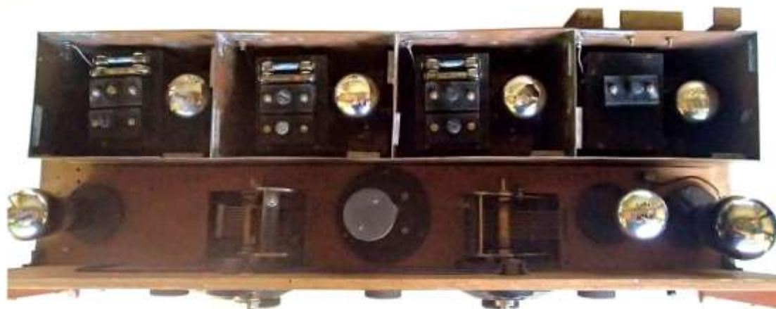
**Bild 2: Selbstbau-Superhet ausgebaut (ohne Abschirmdeckel)**
