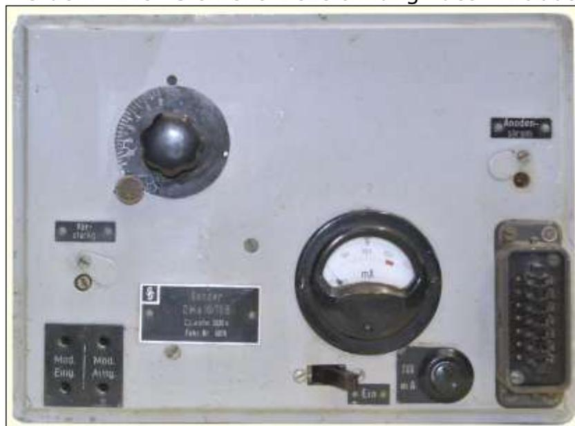
(Dezimetersender 10 Watt,  $\lambda=70$  cm). Der Sender mit den Abmessungen 25x18x14 cm ist dafür vorgesehen, direkt hinter dem Antennenkasten unter einer Schutzhaube montiert zu werden. Seine Stromversorgung bezieht er aus dem bis zu 150 m abgesetzten Bedienungsteil. Im oberen Teil des Geräts ist der Gegentaktsender mit zwei Röhren LD 2,
