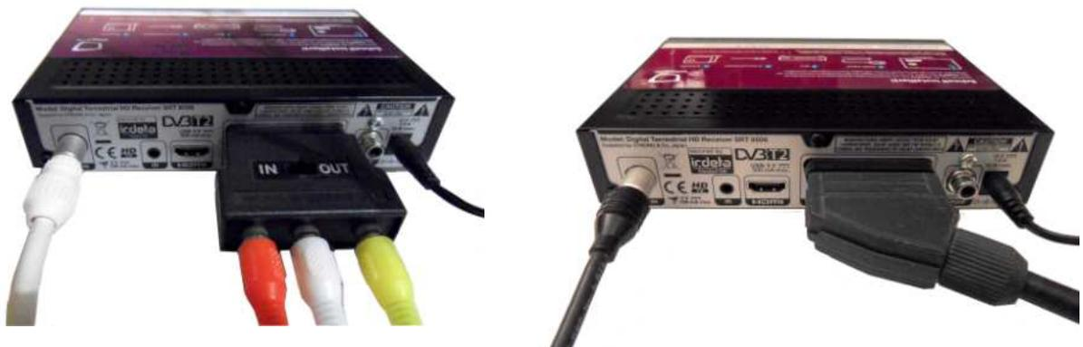
***Anschlüsse der DVB-T2 Box an der Rückseite (links mittels SCART-CINCH-Adapter). Jeweils ganz links am Foto sehen Sie den Anschluss der Zimmer- oder Außenantenne***
