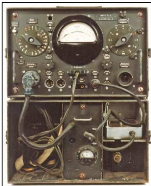
Das **Werkstatt-Prüfgerät WPrG.Fu.b** ist in einem Doppelgehäuse untergebracht. Die Nr. 0049/44 weist auf eine Kleinserie hin, die wohl auch bei den Armee-Nachrichtenwerkstätten im Einsatz gewesen ist.<sup>2</sup> Im unteren Tornister sind ein
