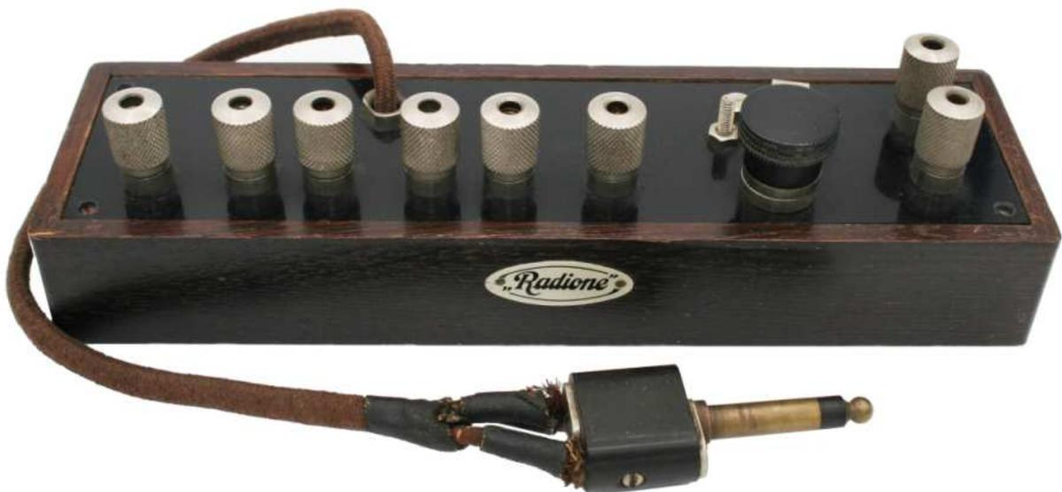
**Kopfhörerverteiler** von RADIONE mit einem KAPSCH Klinkenstecker
