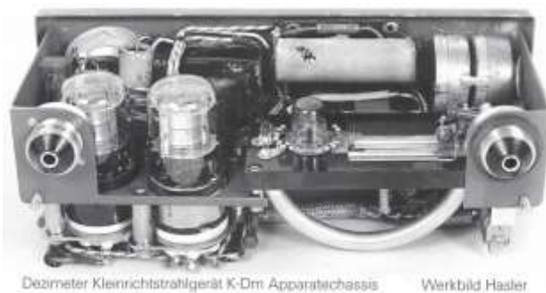
Dezimeter Kleinrichtstrahlgerät K-Dm Apparatchassis Werkbild Hasler
