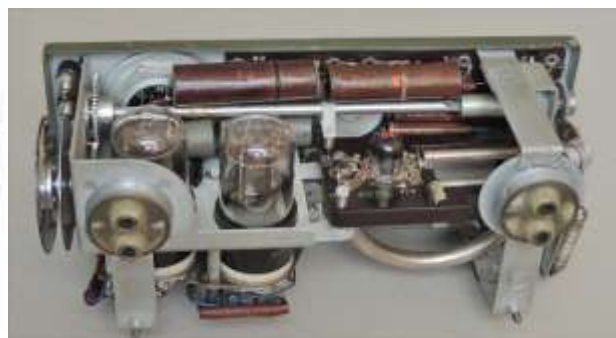
Dezimeter Kleinrichtstrahlgerät K-Dm Apparatchassis Werkbild Hasler
