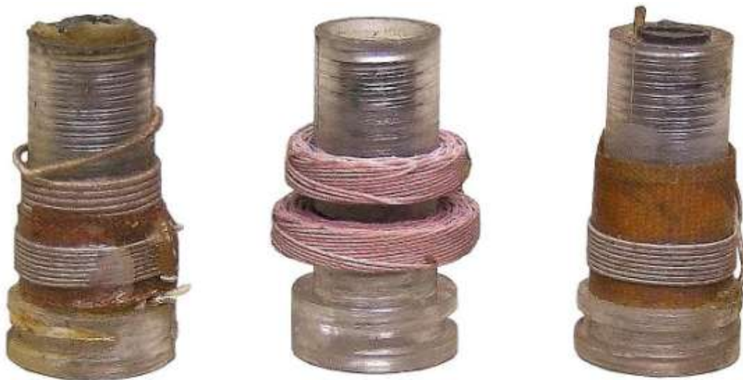
Drei typische Spulen aus dem NIKSCH-Programm für die Industrie: Die Befestigung der Wickelkörper erfolgt durch Einführen und Verschieben in ein ausgestanztes Schlüsselloch in der Montageplatte.
