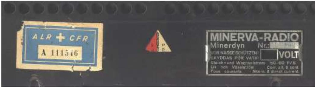
Die Blechrückwand besitzt das originale Typenschild mit der Aufschrift „MINERVA-RADIO Minerdyn“ und die Gerätenummer 102940 und ist mit Holzschrauben in den vier Ecken an Dreieckleisten im Gehäuse befestigt. Neben dem „Funkmastaufkleber“ gibt es noch den typischen Schweizer Aufkleber, beschriftet mit „ALR + CFR“ und der Reg. Nr. 111546.
