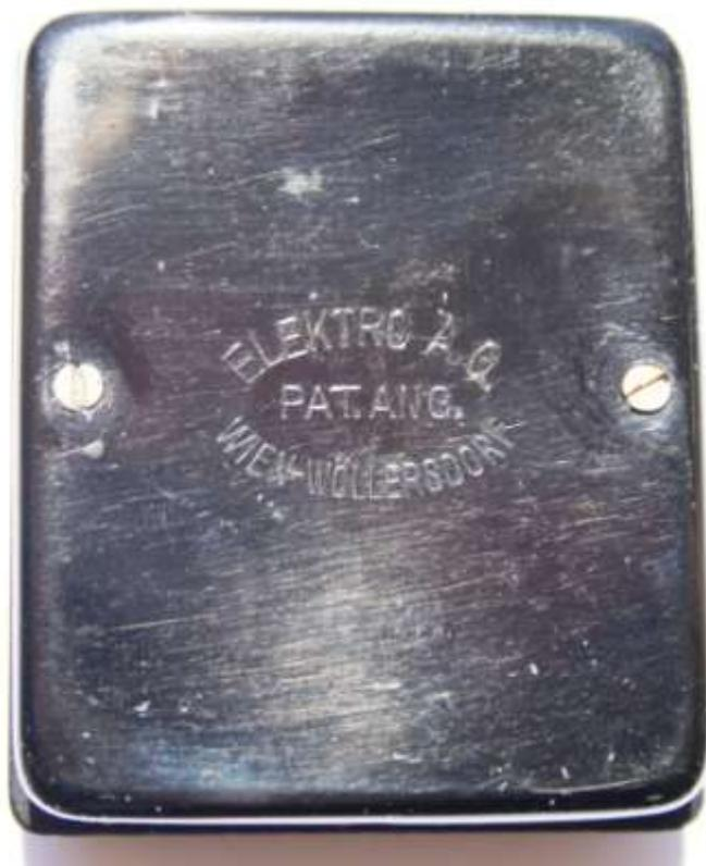
**Detektorgerät der Elektro A.G. Wien-Wöllersdorf, Ansicht des Gehäusebodens**
