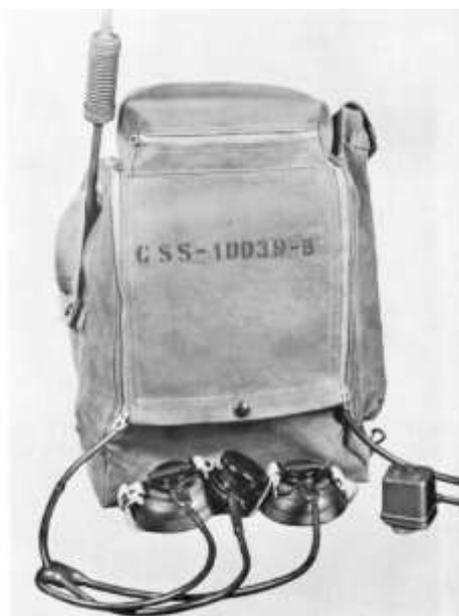
einem Spulenrevolver. Der einstufige Sender ist mit zwei 1,25 V-Eicheltrioden 958A in Gegentaktschaltung bestückt und wird an den Anoden moduliert. Als Modulationsverstärker arbeitet bei A3 die NF-Gegentakt-Endstufe mit der 2 V-Doppelpentode 1E7G (V7) und erzeugt einen Modulationsgrad von 70%. Bei
