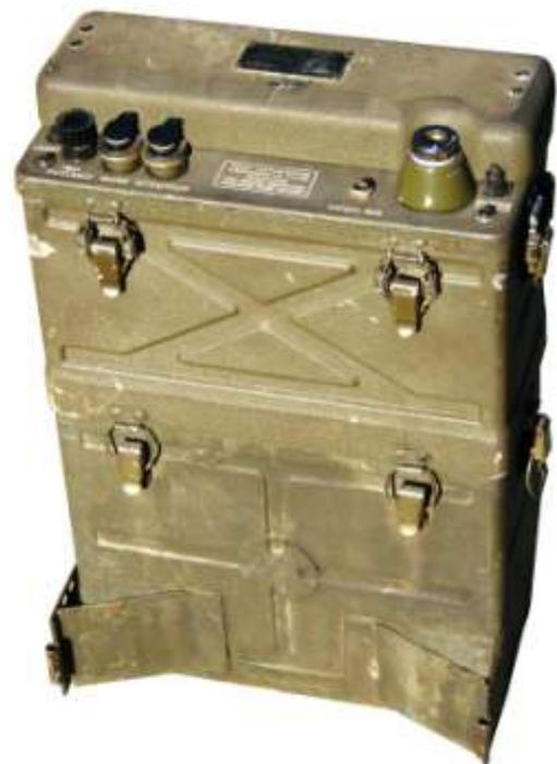
Verglichen mit dem deutschen Torn.Fu.d2 ist das SCR-300 klein, leicht und handlich. Die grundsätzliche Gehäusekonstruktion ähnelt den russischen RRS, RRU und RBS, die Trageweise auf dem Rücken ist aber viel feldtauglicher. Es kann mit einer an 50 Ohm angepassten 83 cm langen Peitschenantenne oder mit einer abgesetzten  $\lambda/4$ -Stabantenne mit 4 Radials auf einem 10 m-Mast betrieben werden.
