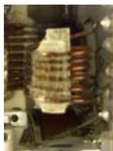
Der mechanische und elektrische Aufbau ist solide, aber ohne großen Aufwand. So sind zum Beispiel die Spulen im Spulenrevolver freitragend aus CuL-Draht gewickelt und mit einem eingeklebten Streifen aus Polystyrol stabilisiert.
