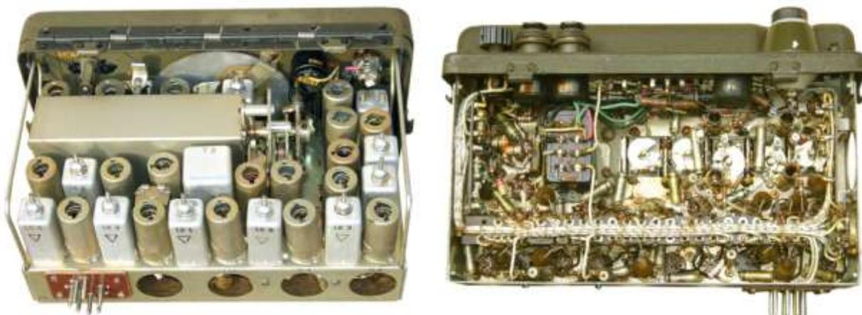
Aber: Sollte man den für die Skaleneichung bei Empfang vorgesehenen Knopf bei eingeschaltetem Sender drücken, kann der Heizfaden der Röhre V2 durchbrennen. Darauf weist das Handbuch hin. Der Aufwand für eine narrensichere Schaltung wäre gering gewesen. Unverzeihlich! Ein Betrieb des Senders ohne angeschlossene Antenne kann die Senderöhre überlasten. Das ist normal.
