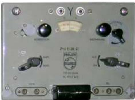
Die Marine-Bezeichnung **Phi1UK41** gibt Hersteller, Sendeleistung, Wellenbereich und Einführungsjahr an. Bemerkenswert ist, dass die Typbezeichnung DR25b1X unter dem Philips-Signet im Layout der Frontplatte enthalten, die deutsche Bezeichnung aber handschriftlich nachgetragen ist. Die Serie 1941 wurde bei N.S.F. gebaut.
