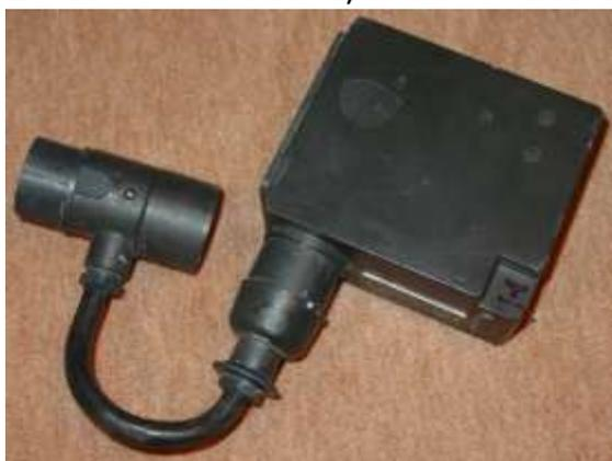
auch eine vierpolige Anschlußbuchse für den Frequenzprüfer hat. Über dieses Kabel wird das Prüfgerät mit den Betriebsspannungen der Funkgeräte mitversorgt. Das Gerät hat einen 2830-kHz-Quarzoszillator mit einem auf die 9. bis 16. Oberwelle (25 bis 48 MHz) abgestimmten Anodenkreis. Mit nur geringfügigen Abweichungen sind 1940 das **Fprüf.e** (für das Funksprechgerät a, den Ukw.E.e und die h-Geräte 10 W.S.h und Ukw.E.h) und
